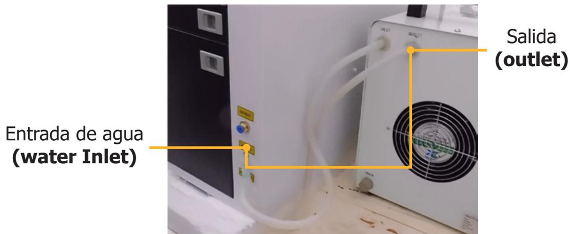
**Nota:** Antes de iniciar con el funcionamiento del equipo láser, asegúrese que el agua circule de manera adecuada dentro del tubo láser CO<sub>2</sub>, este debe ingresar por el extremo izquierdo y salir por el extremo derecho (**por donde está ubicado el primer espejo**), la temperatura del agua no debe ser superior a 36°C, el Chiller es un equipo que regula y mantiene el agua a temperatura ambiente para el buen funcionamiento del tubo láser CO<sub>2</sub>.
