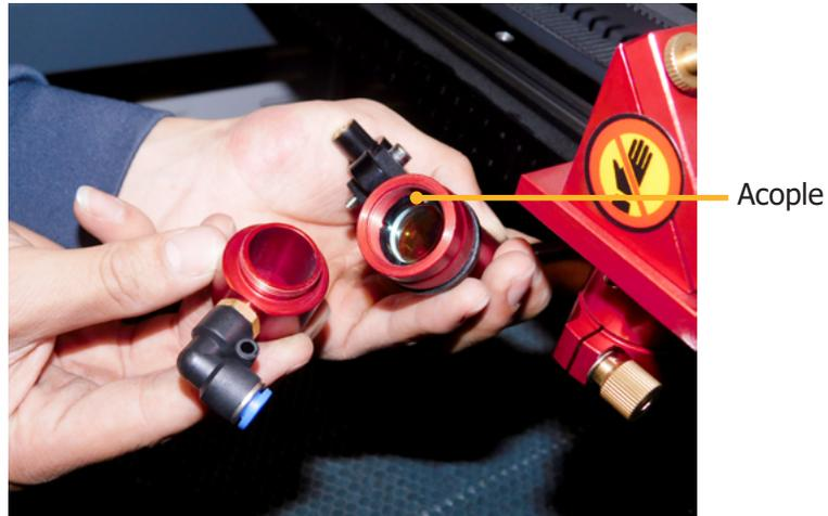
Debe tener en cuenta que antes de realizar el mantenimiento del eje Z, debemos limpiar muy bien estas piezas (**retirar polvillo y residuos de material**), a estos elementos se les debe aplicar grasa para evitar atascos.
