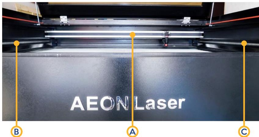
Para poder tener acceso y lubricar los rieles, debemos levantar la correa protectora presionando uno de los costados y sujetando el otro para que el riel sea visible, de manera cuidadosa aplicamos lubricante en el riel.
