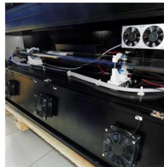
Abra la placa de la cubierta del tubo láser posterior
